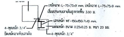
ขยายฐานเสาเหล็ก C1
